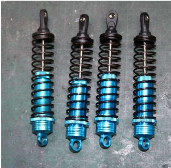
Diese Dämpfer enthalten meist nur einige Tropfen eines undefinierten Öls. Damit die Dämpfer einen gewissen Widerstand erzeugen fülle ich diese Dämpfer mit einem hochviskosen Öl, das normalerweise für RC-Car-Differential verwendet wird.
