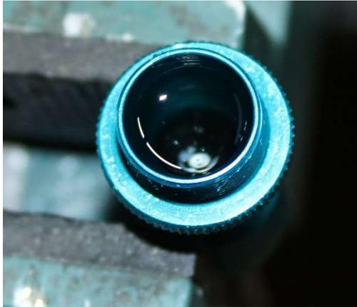
Zum Entfernen der Luft aus dem jetzt unteren Bereich schiebe ich dann den Kolben langsam zur Hälfte hoch und ziehe ihn nach einer Weile (ca. 1-2 Min) langsam wieder heraus. Dabei steigen einige Luftbläschen durch den Kolben auf.
