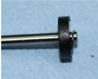
Nach dem Entfernen der Kugelpfanne lässt sich die Kolbenstange aus dem Dämpfer ziehen. Dann entferne ich mit einem feinen Schraubendreher den E-förmigen Sicherungsring. Der Kolben lässt sich jetzt einfach von der Kolbenstange abziehen. Jetzt lege ich den kleinen Glasfaserring, Ø7mm Bohrung Ø3,7mm 1mm dick, auf den Sicherungsring und stecke den Kolben wieder auf. Der E-Ring sichert dann den Kolben wieder auf der Kolbenstange.
