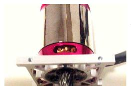
Motor entfernen. Original Ritzel abnehmen und neues Ritzel montieren Wurmschraube noch nicht verkleben für spätere Einstellung!
